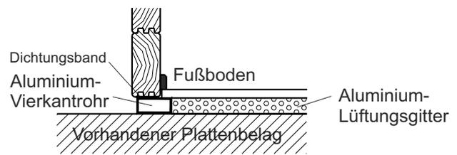
Alu-Vierkanthrohre als Wand- u. Bodenaufgabe. Als Bodenbelag kommt hier nur eine OSB-Platte in Frage. Unter 2 Wandseiten wird ein Alu-Lochprofil zur Belüftung eingebaut. Wenn kein Fußboden eingebaut wird ist unter allen Wandseiten ein Alu-Vierkanthrohr.
