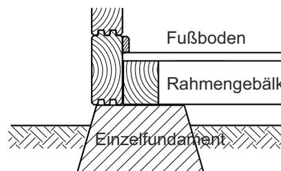
Rahmengebälk aus Douglasie nach statischen Erfordernissen. Auf Wunsch kann zwischen den Balken eine Wärmedämmung mit Blindboden eingebaut werden.
