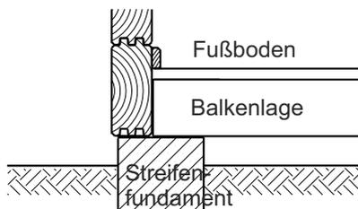
Balkenlage aus Douglasie nach statischen Erfordernissen. Auf Wunsch kann zwischen den Balken eine Wärmedämmung mit Blindboden eingebaut werden.
