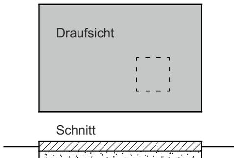
Die Betonplatte ist die idealste Fundamentart. Sie wird in der Regel "schwimmend" ausgeführt also ohne Fundamente, nur auf einem Schotterbett. Das Außenmaß soll kleiner sein als das Haus, damit das Regenwasser an den Wänden abtropfen kann. Das genaue Maß ist aus dem Fundamentplan ersichtlich, den Sie bei der Bestellung erhalten. Die Oberkante soll mindestens 8 cm über dem Gelände liegen.
