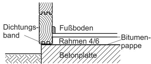
Imprägnierte Rahmen 4/6 und Bitumenpappe als Feuchtigkeitssperre. Auf Wunsch kann zwischen den Rahmen eine Wärmedämmung eingebaut werden. Hier kann auf einen Holz-Fußboden verzichtet werden. Alternativen sind z.B. Estriche oder Plattenbeläge
